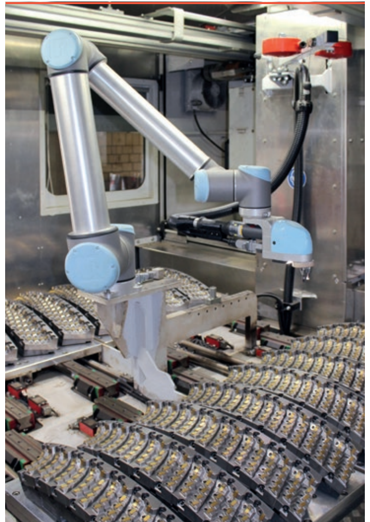
Fräsersegmente mit Wendepplatten
