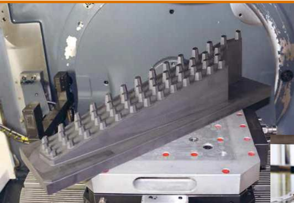
Eine Spezialität von Finke sind Elektroden aus Graphit für das Senkerodieren,...
